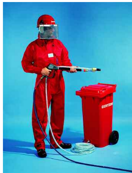
TORNADO Wasser-Sandstrahlssystem mit Borcarbidgehäuse. Mit Helm, Visier, Gehörschutz und Brille, sowie Strahlmittelbehälter mit Sandsaugschlauch. Zubehör: wasserdichter Overall
